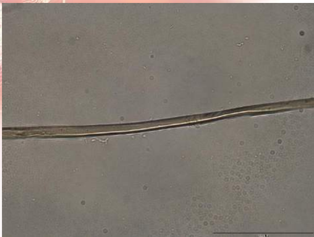
纤维纵向400倍显微照片
