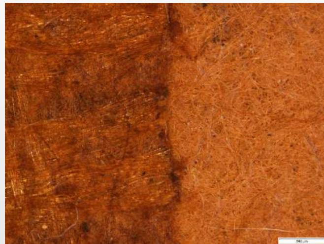
补绢边缘显微结构， 可以看出在补绢与命纸之间没有托纸
